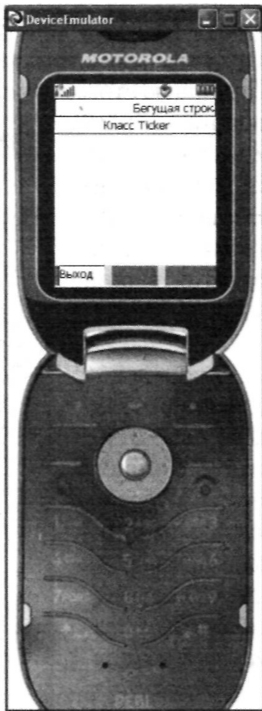
Рис. 6.12. Объект класса Ticker создает в верхней части экрана бегущую строку
